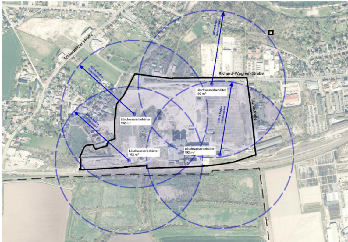
Abbildung 44: Mögliche Positionierung von Löschwasserbehältern sowie Einzugsradien © ICL 2024
