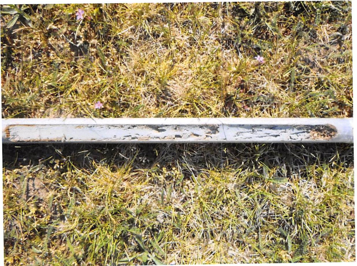
Bild 6: Bereich 4,5-5,0 m (Bohrung 5), Ton, schluffig, schwach sandig.
