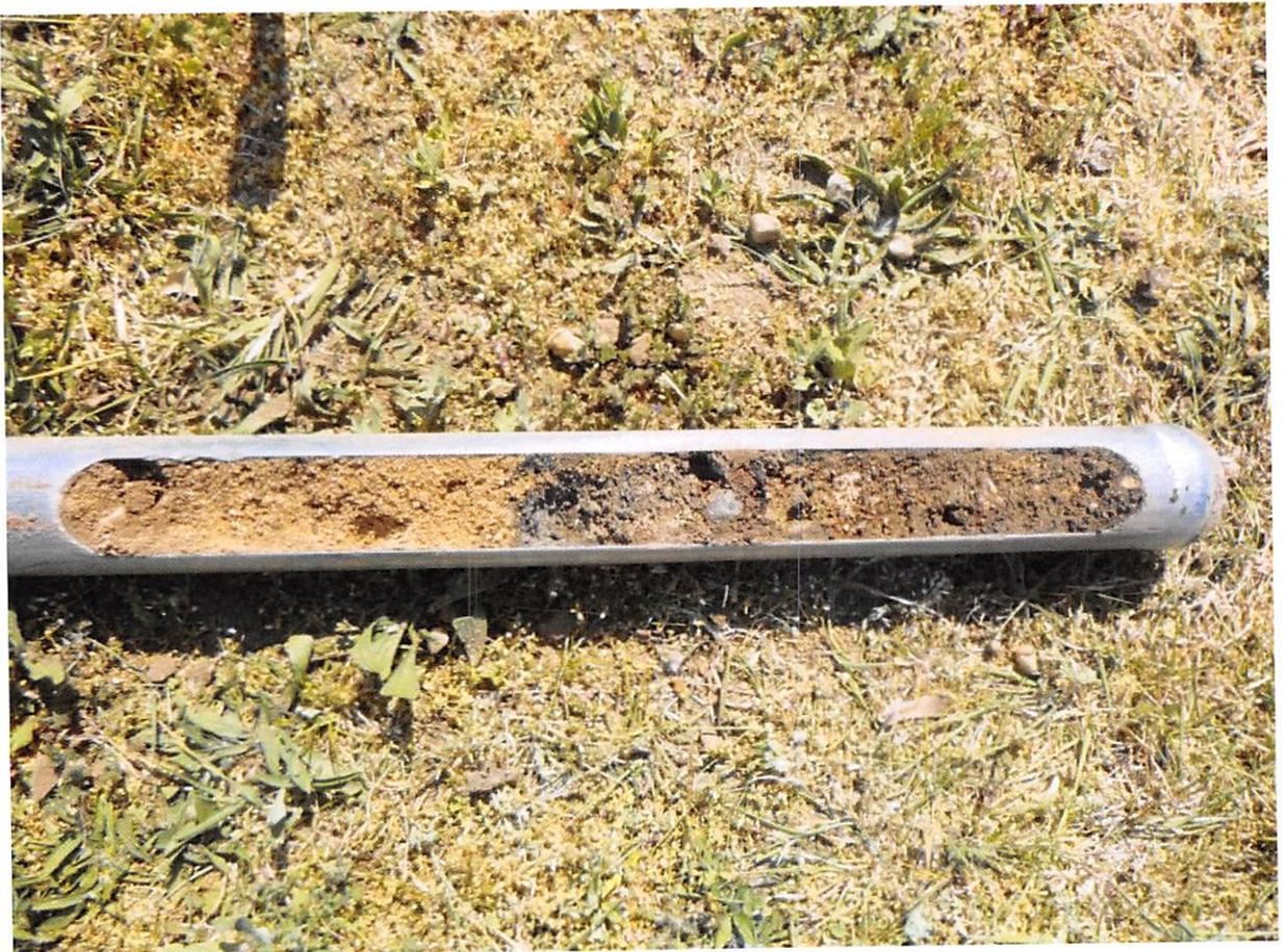
Bild 4: Bereich 0,5-1,0 m, Mittelsand, kiesig, schluffig, Fremdstoffe, Auffüllung.
